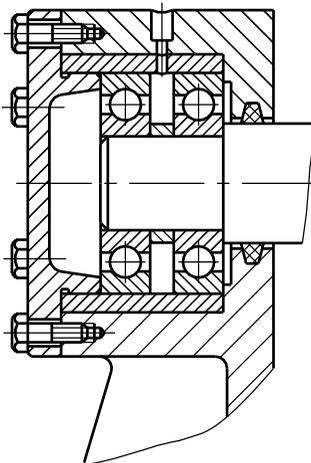
Рисунок 1. На фрагменте чертежа сборочной единицы крышка изображена с минимальным количеством упрощений
