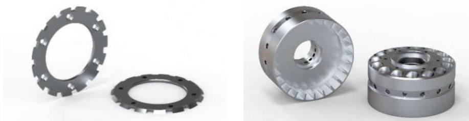
Рисунок 2 – 3D-модели кольца ограничительного и маховика
