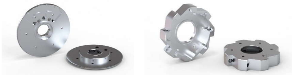
Рисунок 1 – 3D-модели крышки и чаши сопловой
