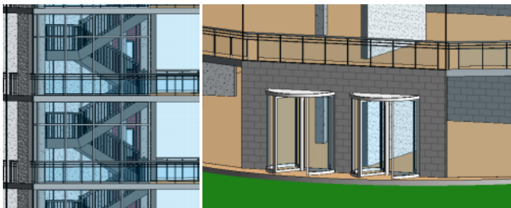
Рисунок 2. Монолитная лестница и входная вращающаяся дверь
