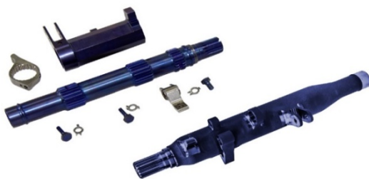
Рисунок 3. Валы блокировки двери самолетов A350, напечатанные на 3D-принтере
