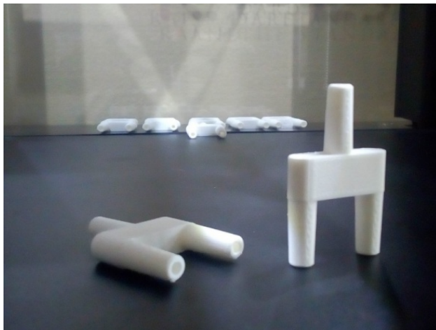
Рисунок 3. 3D-печать тройников для аппаратов кислородного обеспечения
